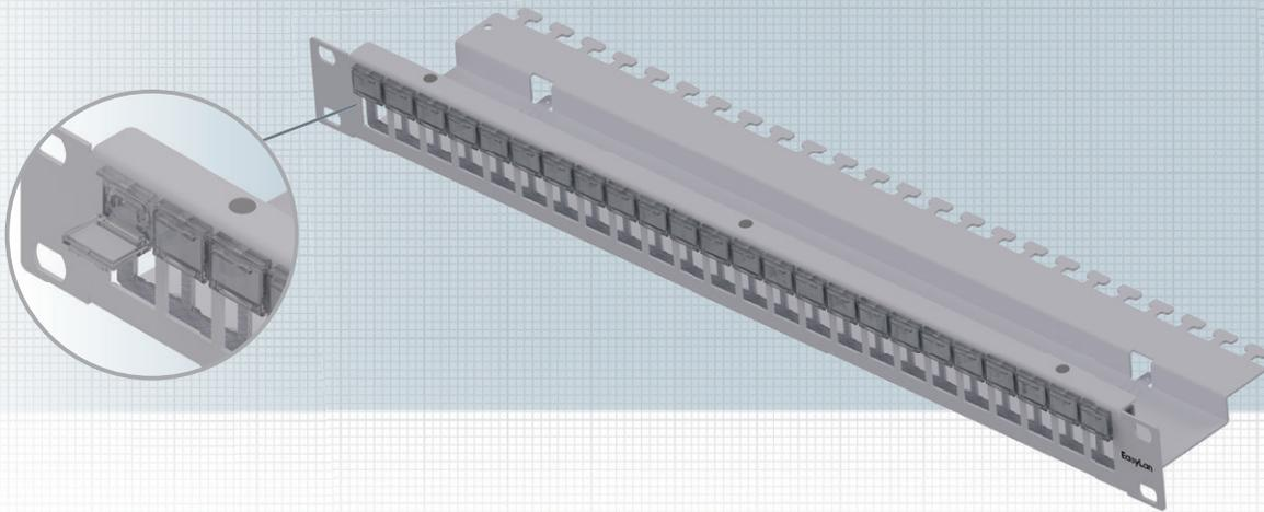
Das Verteilerfeld 19" 1HE ist beschaltbar mit bis zu 24 preLink® / fixLink® RJ45 Keystonemodulen. Das Verteilerfeld ist in zwei Ebenen aufgebaut. Somit sind die Module bündig in der Frontplatte. Das Verteilerfeld kann wahlweise in Edelstahl oder pulverbeschichtetem Eisenblech bestellt werden.
